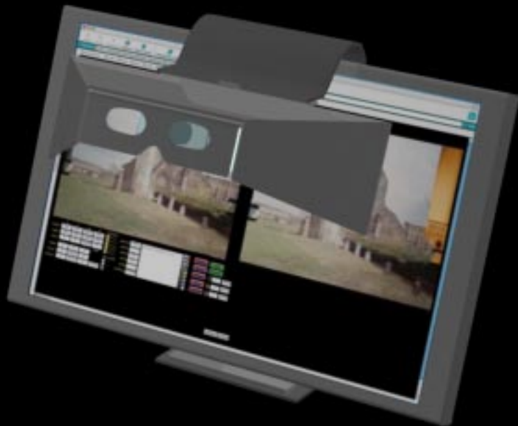
stereoscopio a specchi per monitor
